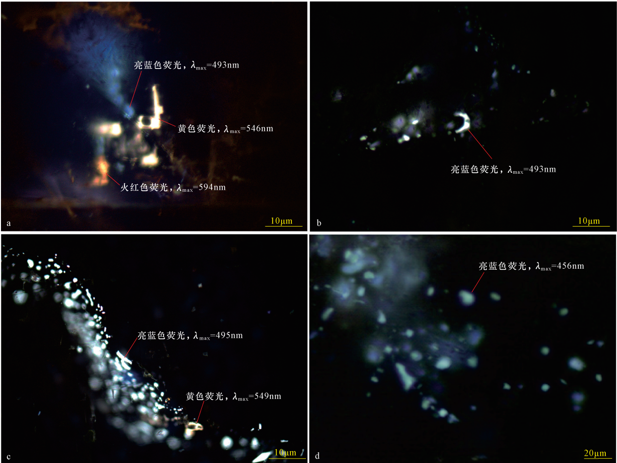
图 5 塔河油田奥陶系油包裹体荧光照片
